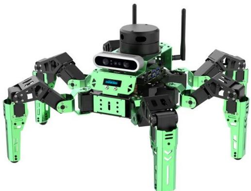
El JetHexa es un robot hexápodo avanzado impulsado por la potente NVIDIA Jetson Nano B01, diseñado para el aprendizaje, investigación y desarrollo en robótica e inteligencia artificial. Su estructura metálica de alta resistencia y sus servomotores inteligentes HX-35H garantizan precisión y estabilidad en el movimiento.
